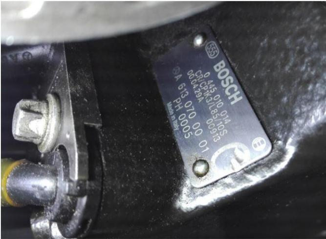
Pompa di iniezione del carburante OM613
